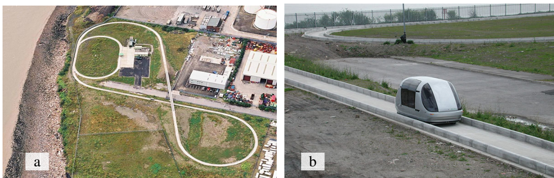
Figura 1 – Vista geral do projeto ULTra (a) e detalhe do veículo (b)
